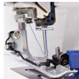
Automatische draadvoer in de naald
